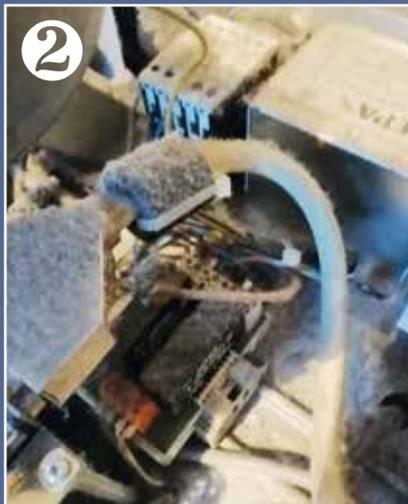
FOTO 2 - Troppo sporco. Una delle cause di rottura dell'elettronica è questo.
